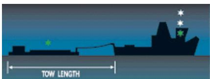
Kad je duljina tegljenog plovila ispod 200 m, pokazuju se dva jarbolna svjetla (tri jarbolna svjetla ako je preko 200 m). ŽUTO svjetlo za tegljenje nalazi se iznad krmenog svjetla. Tegljeno plovilo pokazuje bočna svjetla i krmeno svjetlo.
