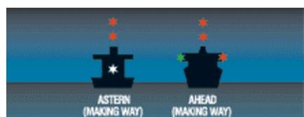
Dva kružna crvena svjetla i, kad napreduje kroz vodu, bočna svjetla i krmeno svjetlo (brodice kraće od 12 m ne trebaju pokazivati takva svjetla).
