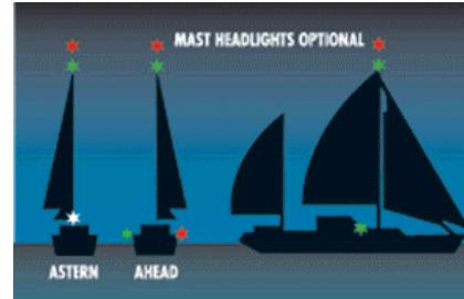
Jedrilice dok plove moraju pokazivati bočna svjetla i krmeno svjetlo. Osim toga, mogu pokazivati na vrhu jarbola dva kružna svjetla vertikalno postavljena, crveno iznad zelenog.
